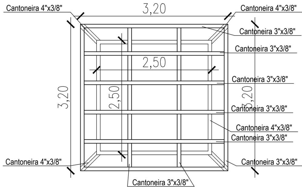
DETALHE - ESTRUTURA BASE DO RESERVATÓRIO
